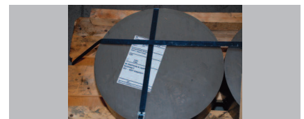
Silberstahl 1.2210 115CrV3 Ausführung: geschliffen
